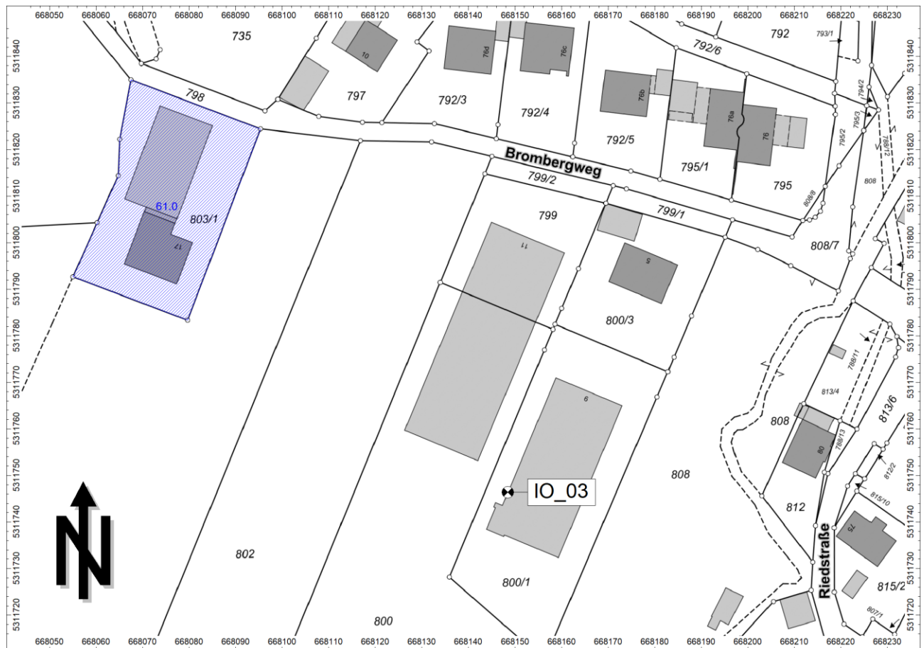
Abbildung 3: Lageplan mit Darstellung des als Vorbelastung am IO_03 berücksichtigten Flächenkontingents des Flurstücks Nr. 803/1
